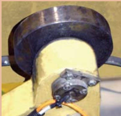
Sekundärarmens kraftgivare monteras i rullen direkt vid tambourjärnet
